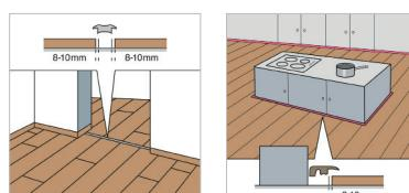
Ламинат BerryAlloc следует укладывать плавающим способом, что означает, что пол должен иметь возможность двигаться:
